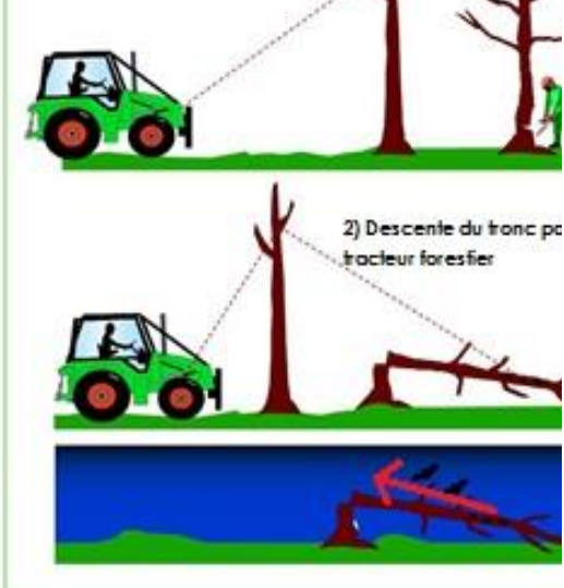
Schéma de l'abattage « doux » des arbres
