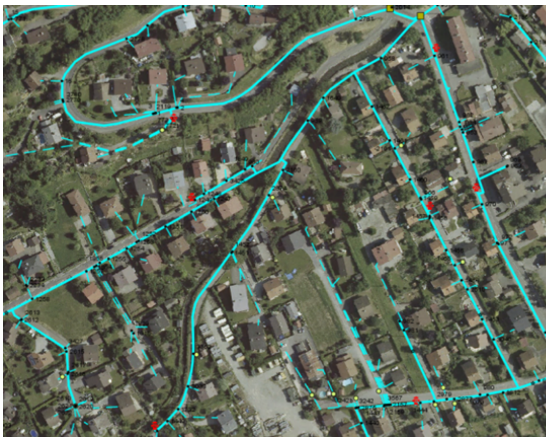
Schéma du réseau de distribution d'eau potable.
